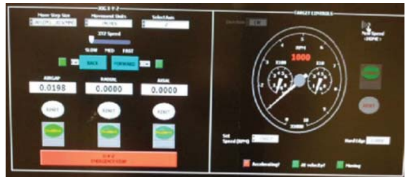
Şekil 3. Hedef dönüşü ve numune konumunu tam olarak kontrol etmek amacıyla özel bir yazılım uygulaması kullanılmıştır.
