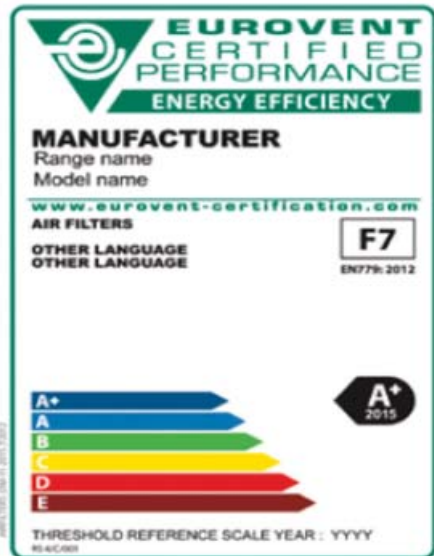
Resim 2: Hava filtresi için Eurovent Enerji tasarruf etiketi
