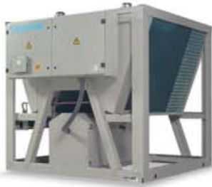
120 - 600 kW, Hava Soğutmalı, Vidalı Kompresörlü, R134a Gazlı
