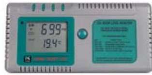
Şekil 2. İç hava sıcaklık ve CO2 on-line ölçüm cihazı
