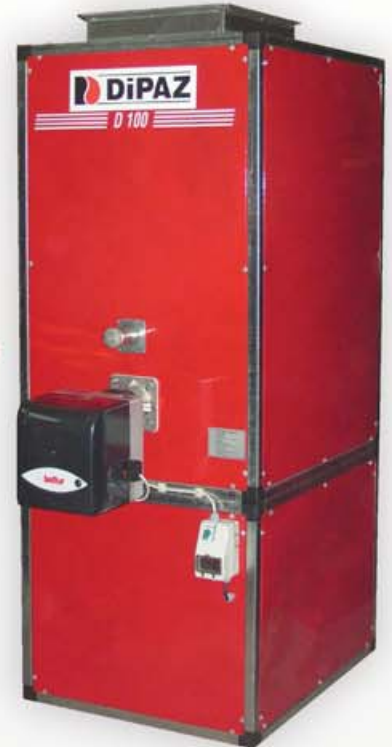
Dipaz D ve DS Serisi Kanal Bağlantılı Doğalgaz Brülörlü Sıcak Hava Cihazları Kapasiteler: 30.000 - 300.000 kCal/h
