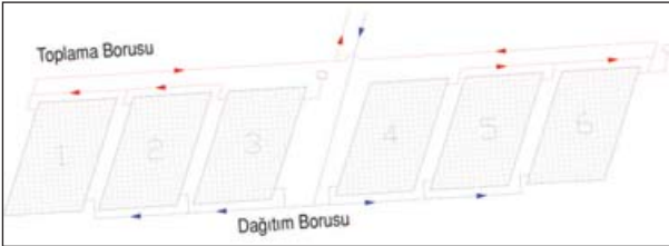
Şekil-3 Tesisatlarda, havanın otomatik tahliye cihazları ile uzaklaştırılması ve cihazın yeri
