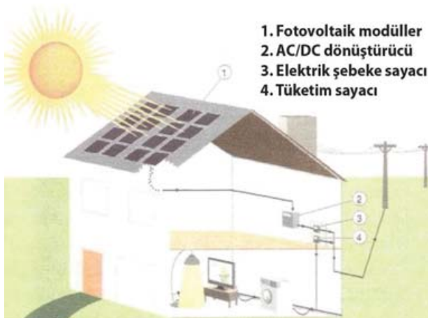
Şekil 5. Şebekeye bağlı fotovoltaik sistem şeması [2]
