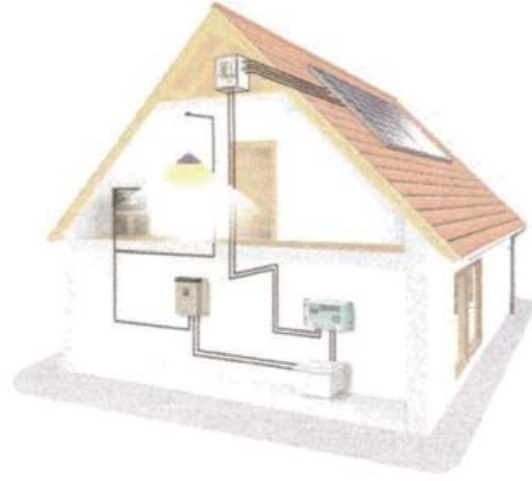
Şekil 6. Şebekeden bağımsız fotovoltaik sistem şeması [2]
