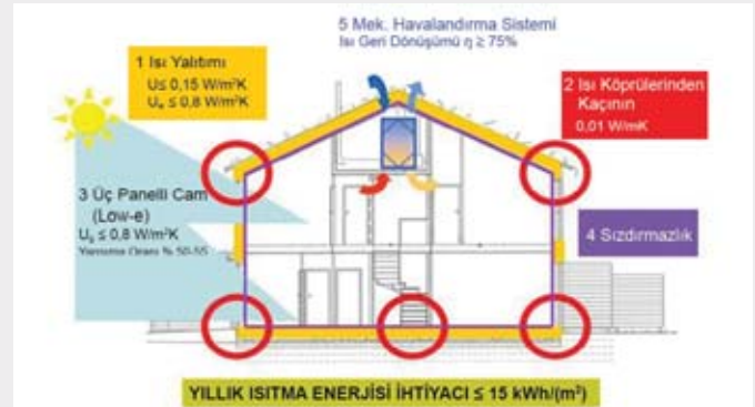
ŞEKİL 1.2 - PASİF EV STANDARDI 5 ANA İLKESİNİN ŞEMATİK GÖSTERİMİ
