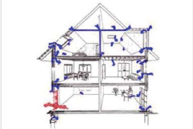
ŞEKİL 1.5 - HAVA BASINCI TESTİNİN ŞEMATİK GÖSTERİMİ
