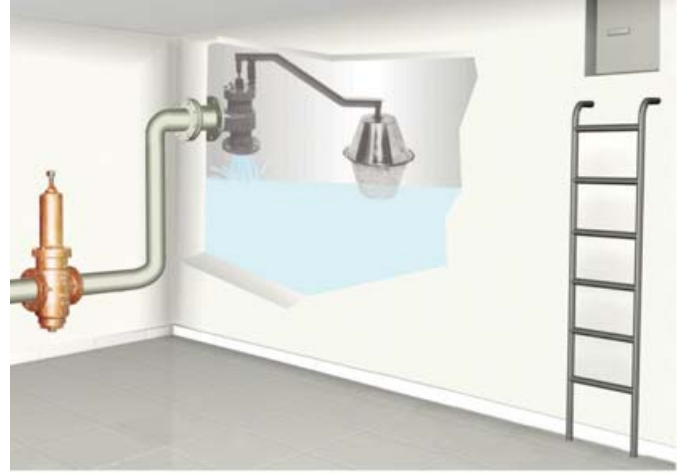
Şekil 1: Mekanik şamandıralı vana, yüksek difraksiyel basınç, yüksek gürültü, yüksek kaviteasyon, montaj zorluğu, düşük vana ömrü, düşük performans
