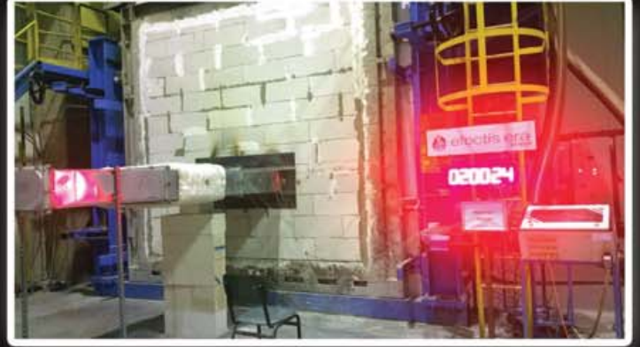
Galvaniz Havalandırma Kanalı Testi
