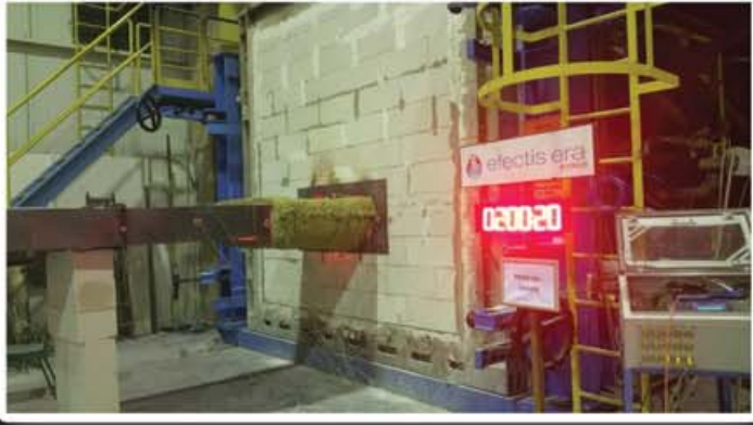
Dkp-Siyah Kaynaklı Havalandırma Kanalı Testi
