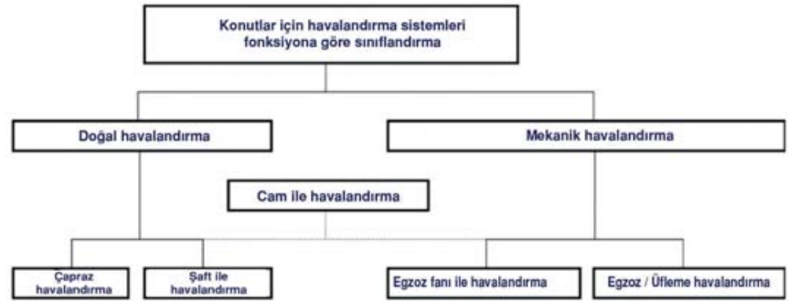
Şekil 3 Havalandırma Sistemlerinin Sınıflandırılması (DIN 1946 – 6)
