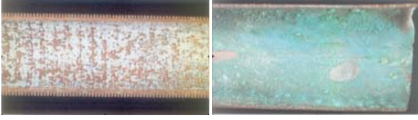
Akışkan içerisindeki koroziye Korozyona sebep olan küf, alg elementlerin varlığı sebebiyle ve balçık tortuları. boru iç yüzeyinde oluşmuş minik çukurlaşma bölgeleri.
