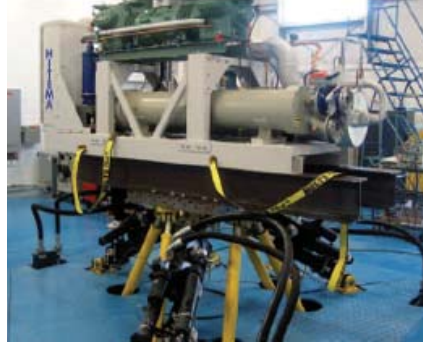
Şek.6: Vida kompresörlü su soğutmalı soğutma ünitesi, sismik test aşamasında
