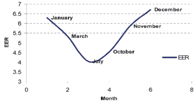
Şekil 3: Serbest soğutmaz soğutma ünitesi EER değeri
