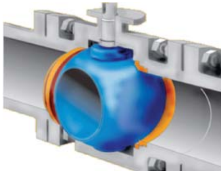
Şekil 4 Küresel Vana Çalışma Prensibi
