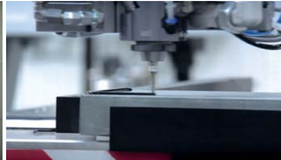
Uygun iki bileşenli yerinde contalama için robotlar
