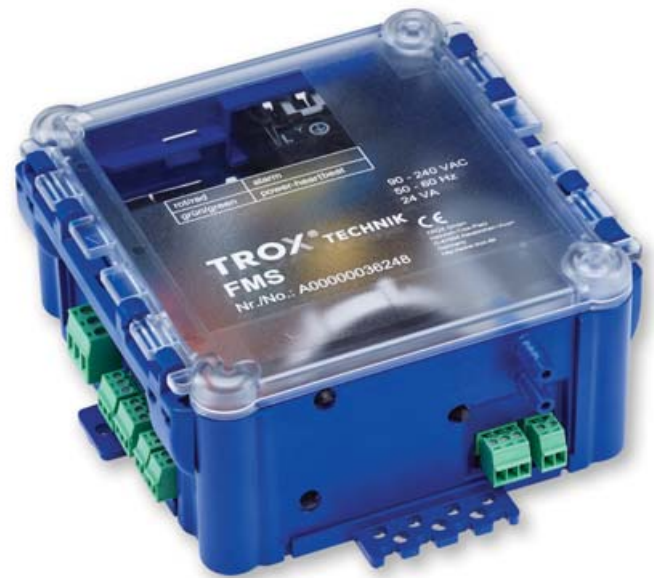
Resim-2: Yeni FMS izleme sistemleri; çeker ocaklarında, duman davlumbaz alınlarında ve benzer parçalarda debinin veya davlumbaz alın hızlarının elektronik takibinde kullanılır ve kendi gücünü kendi sağlar.
