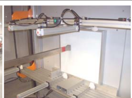
Tarama Testi (Scan Test / EN 1822-4)
