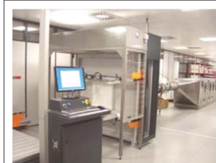
Tarama Testi (Scan Test / EN 1822-4)
