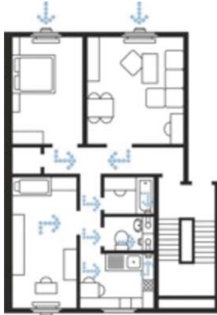
Şekil 2: Bina içi hava kontrol sistemi odalara gerektiğinde temiz hava sağlanmasını garantiler.
