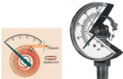
Şekil 7. Spiral Bourdon tüplü manometre
