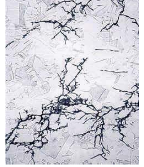
Resim 2: 316 paslanmaz çelik kimyasal proses boru sistemi. Östenitik paslanmaz çelikte klorid gerilim korozyonu çatlağı - yıldırım- formunda çatlak oluşumu
