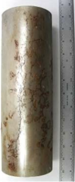
Resim 1: Klorid Gerilim Korozyon Çatlağına maruz kalmış östenitik paslanmaz boru
