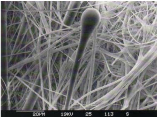
Şekil 2. HEPA Filtrenin İç Yapısı
