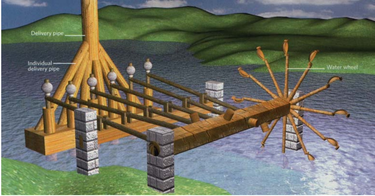
Takıyüddin'in altı silindirli su pompası. Egzantrik mili bağlı milleri kontrol ediyor ve bu sayede su sürekli toplanıyor.
