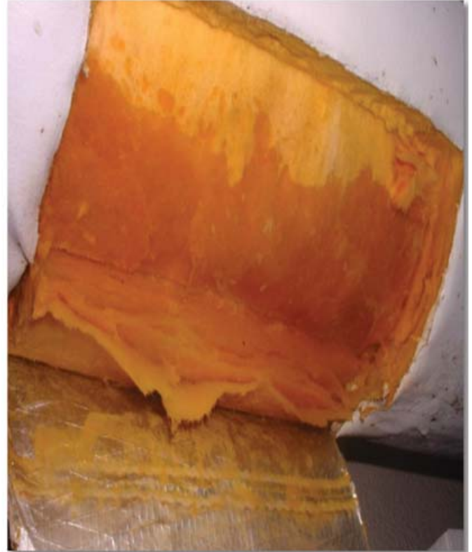
Resim 3: Soğuk hat kullanımında uygulama hatası sonucunda buhar bariyerli kaplamaya rağmen bünyesine nem girişi olmuş ürün
